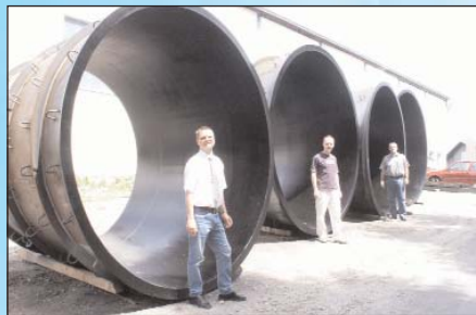
Die Konusabnahme bei Gugler Hydro Energy
