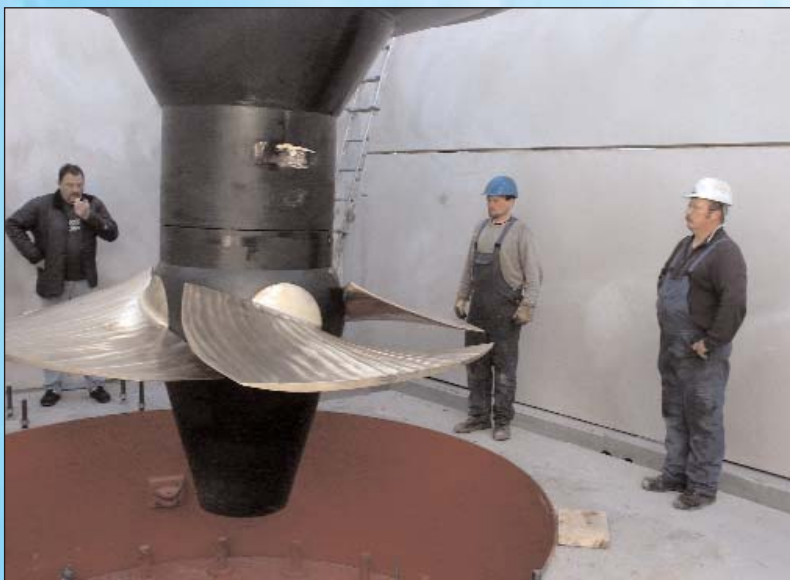
Stolze 2850 mm misst das Kaplan-Laufrad des KW Raudaschl
